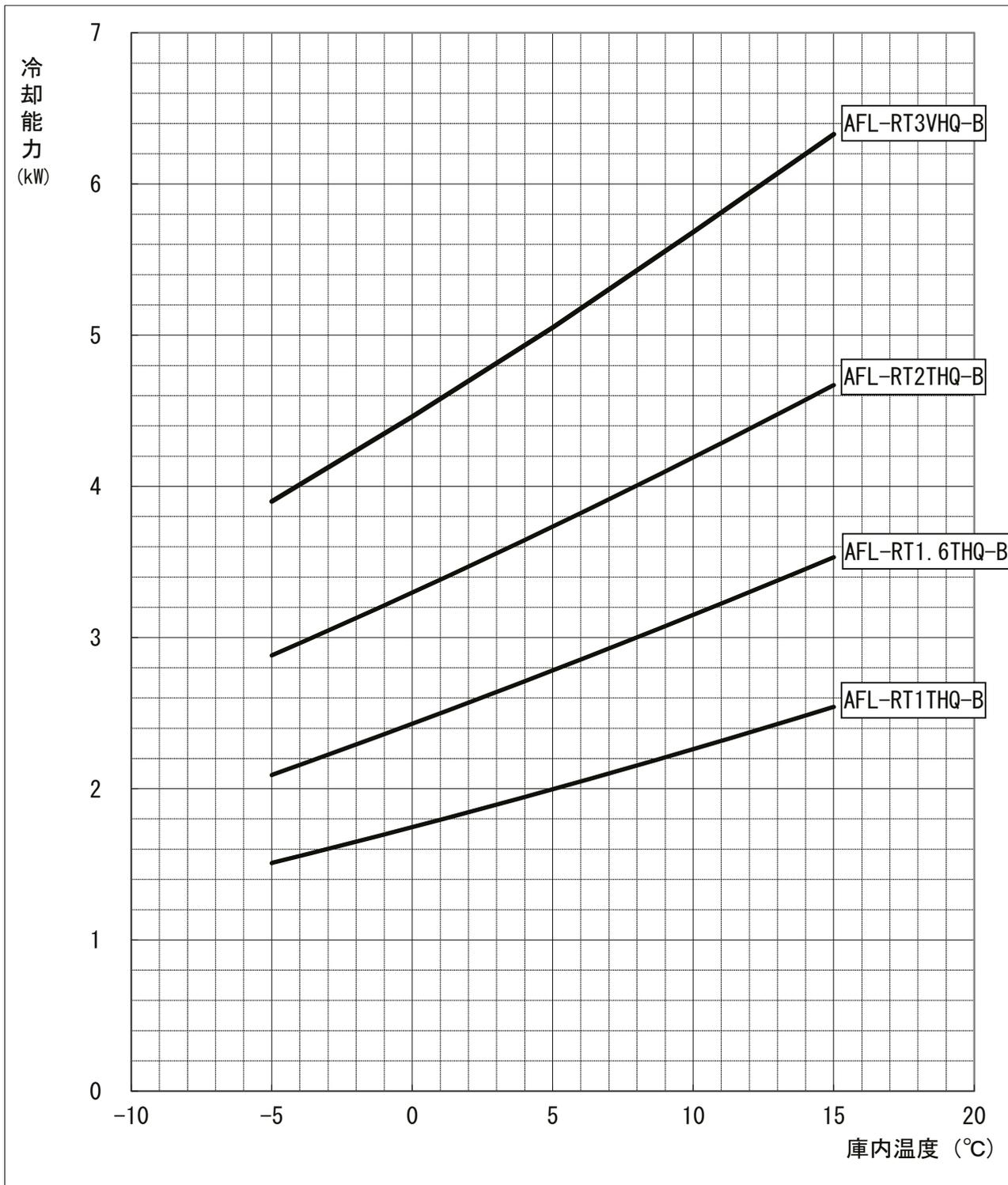
注1. 上記線図は外気32°C、冷媒配管長さ5mにおける値を示します。
