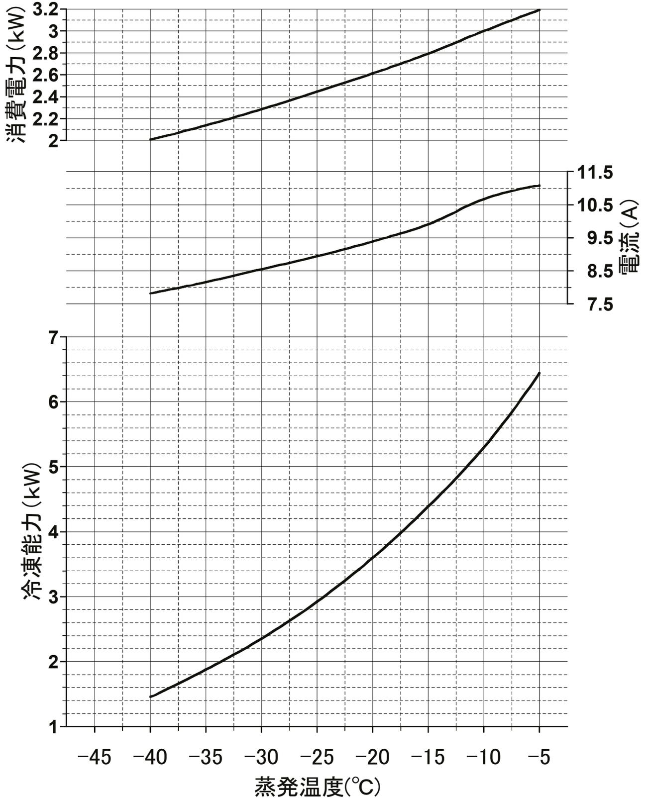
(注1) 蒸発温度は、ある圧力における蒸発器入口温度と露点温度の平均値により求めた温度を指します。
